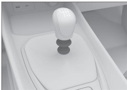
4. Переключите рычаг передач в положение R и отпустите блокировочное устройство.
