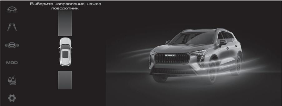
4. Для начала выезда из парковочного места, удерживайте кнопку парковки 2 секунды до звукового сигнала, затем отпустите ее, руль и педаль тормоза. В это время обращайте внимание на окружающую обстановку. После успешного выезда автомобиля с парковочного места система автоматической парковки уведомляет водителя о завершении действия системы. Ему снова рекомендуется взять управление автомобилем на себя.
